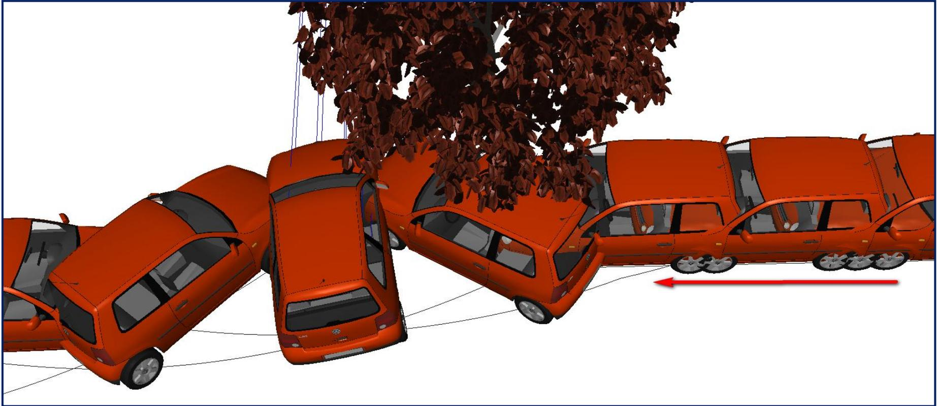
Kollisionsbedingt auferlegte Rotationen des Fahrzeugs können stark unterschiedliche Belastungskenngrößen an unterschiedliche Positionen im Fahrzeug bewirken – im Gutachten muss ggf. darauf eingegangen werden
