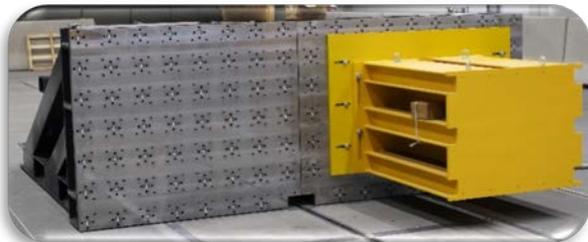
Demontierbarer Crashblock mit Offset-Barriere (Träger für ODB-Block)
